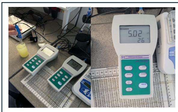
Рис.2 - Определение активной кислотности молочной сыворотки рН-метром.
